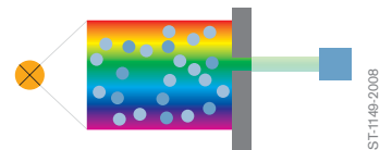
Absorbiert ein Gas den grünen Anteil des eingestrahlenen Lichts, so ist dessen Intensität messbar reduziert.
