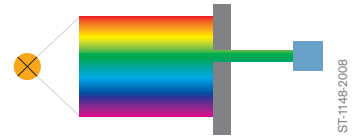
Nur der grüne Anteil des eingestrahlenen Lichts wird herausgefiltert und dessen Intensität gemessen.
